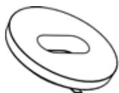
▲ **Bild 1:** Schlitz. Standard bei 17er-Serie.
